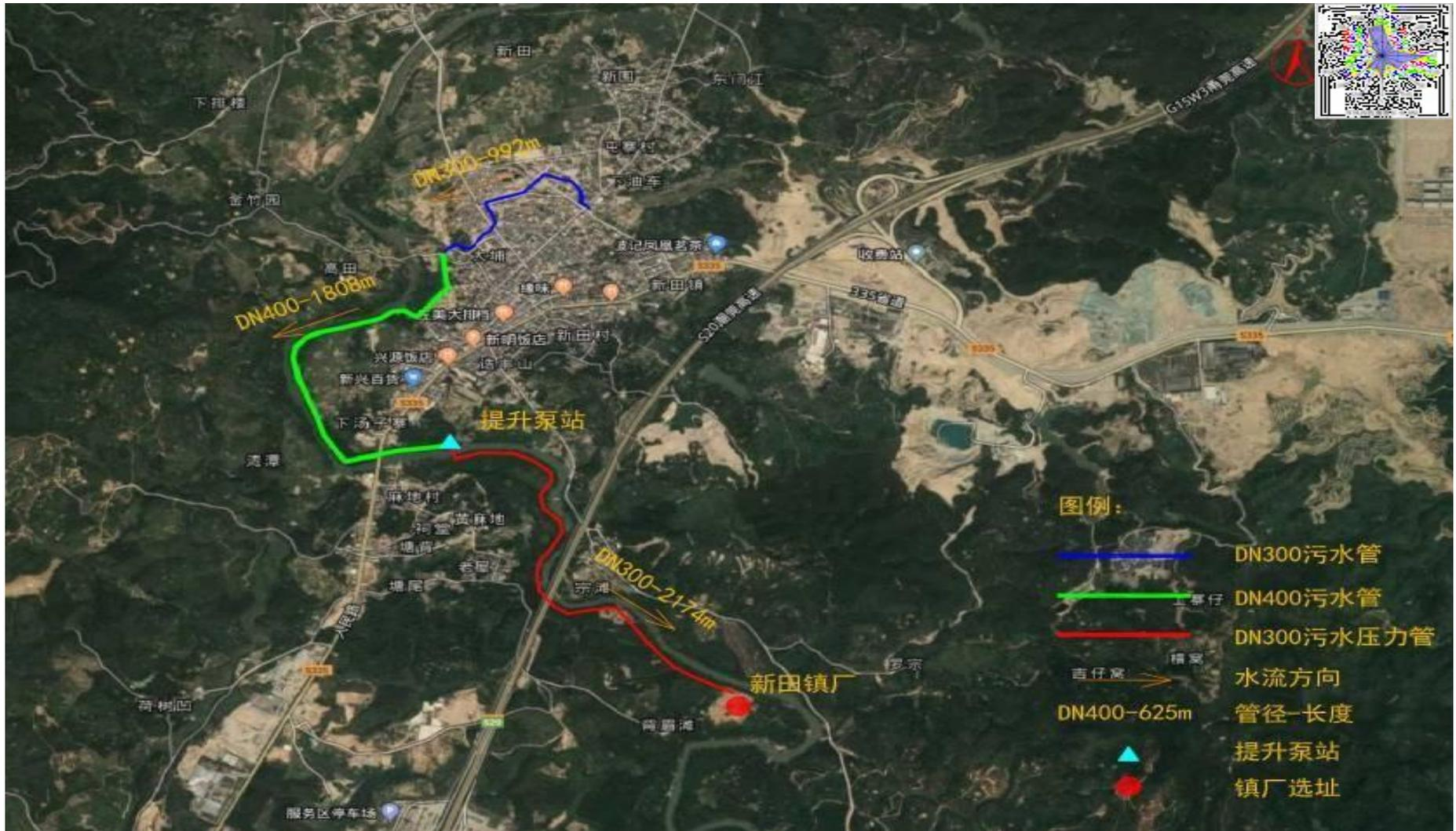
图 3-1-3 污水收集管网图
